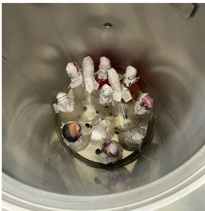
Рис 2 – Помещение лабораторной посуды в автоклав
